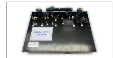
Fixture ISP/FCT para el manipulador EIIT Touch Capacitive
