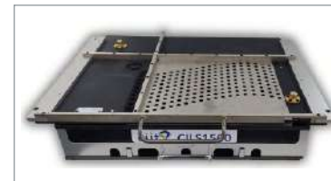
LEDs calibration fixture para el CILS1500 handler de EIIT
