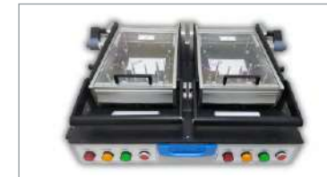
Fixture FCT manual independiente de Ingun (doble posición)
