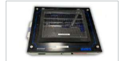
Fixture de vacío manual para el sistema fuera de línea Teradyne
