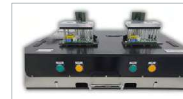
Fixture ISP/FCT para el manipulador EIIT MPP
